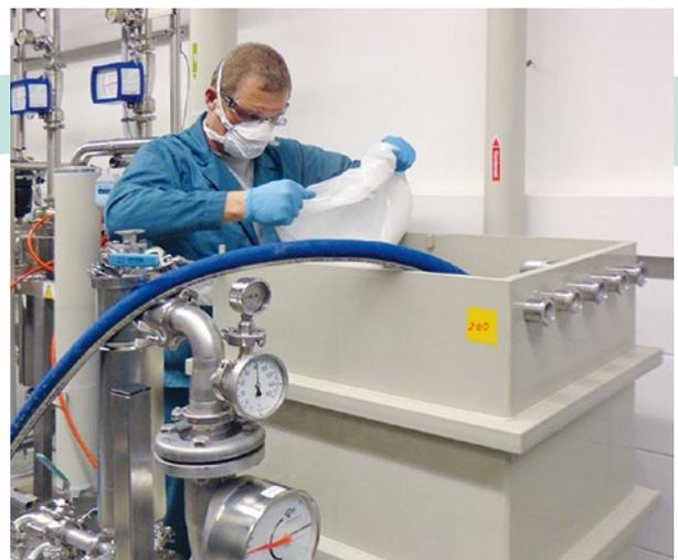
Diese sogenannte Passivschicht kann durch chemisches Passivieren zusätzlich verstärkt werden, um so dem Rouge noch mehr die Grundlage zu entziehen.
